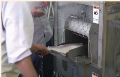
原料を入りに口に横に置きます Laying fish on the conveyor net
